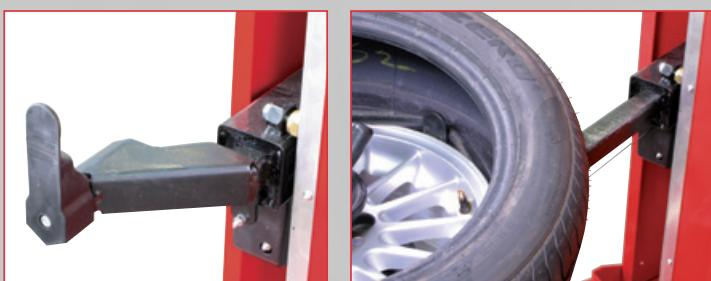
L'utensile inferiore interviene sul secondo tallone, sollevandolo e rimuovendo il pneumatico dal cerchio. Utilizzato anche per il montaggio.
