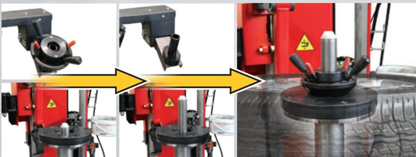
Al sollevamento della ghiera rapida dalla sua sede, l'albero di bloccaggio esce dal piattello permettendo il centraggio e il fissaggio del cerchio in maniera rapida, sicura e senza sforzo. Questo consente maggiore velocità e precisione durante le fasi di bloccaggio e rilascio del cerchio, mantenendo le caratteristiche di sicurezza e adattabilità di un fissaggio meccanico manuale.
