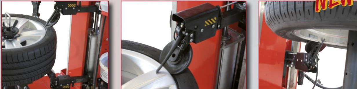
I sensori di prossimità attivano automaticamente il movimento di penetrazione radiale, agevolando lo stallonamento.
