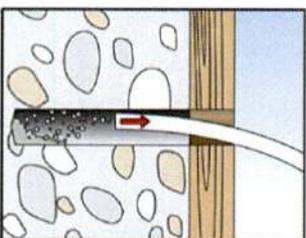
2. Bohrmehl entfernen.
