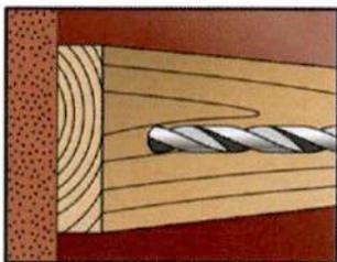
1. Bohrung eines Bohrloches mit  $\varnothing$  8 mm (BXR 8) und  $\varnothing$  10 mm (BXR 10 / BXRLfix 10) mittels der im entsprechenden Anhang angegebenen Bohrverfahren.
