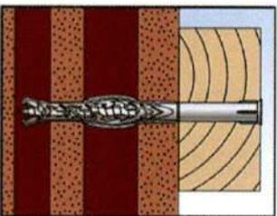
5. Richtig gesetzter Dübel in Hohlmauerwerk.
