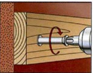
4. Die Schraube wird eingeschraubt, bis der Schraubenkopf an der Dübelhülse anliegt.
