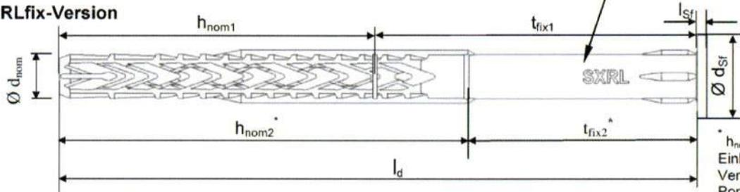
\*  $h_{nom2}$  Zusätzliche Einbindetiefe zur Verankerung in Porenbeton
