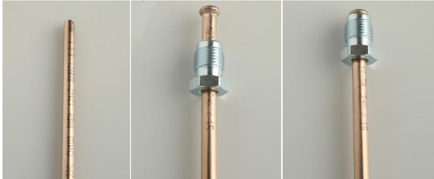
5. Die sauber getrennten und entgrateten Leitungsenden der Ersatzleitung sind mit einem Bördelgerät (gemäß Fahrzeugherstellerangabe) mit der vorgesehenen Bördelform (E oder F) zu bördeln. Es muss die Bördelform des Originalteils verwendet werden.
