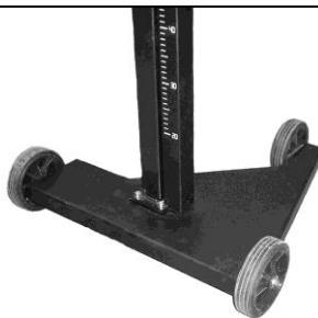
La chambre optique peut être réglée en la faisant coulisser sur des patins en plastique, précis et silencieux, sur une colonne en aluminium sur laquelle se trouve une échelle en centimètres permettant une mise en place précise par rapport au phare.
