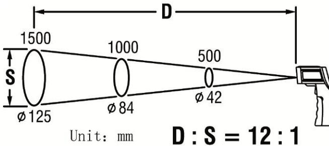
Isto significa que a uma distância de 100 cm a superfície de medição tem um tamanho aproximado de 8,5 cm.
