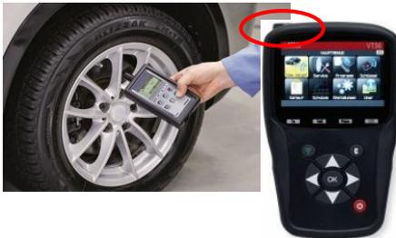
Antenne an Originalsensor halten
