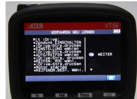
Fahrzeugspezifischer Anlernprozess wird angezeigt
