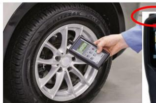
Antenne an Ventil vom Originalsensor halten
